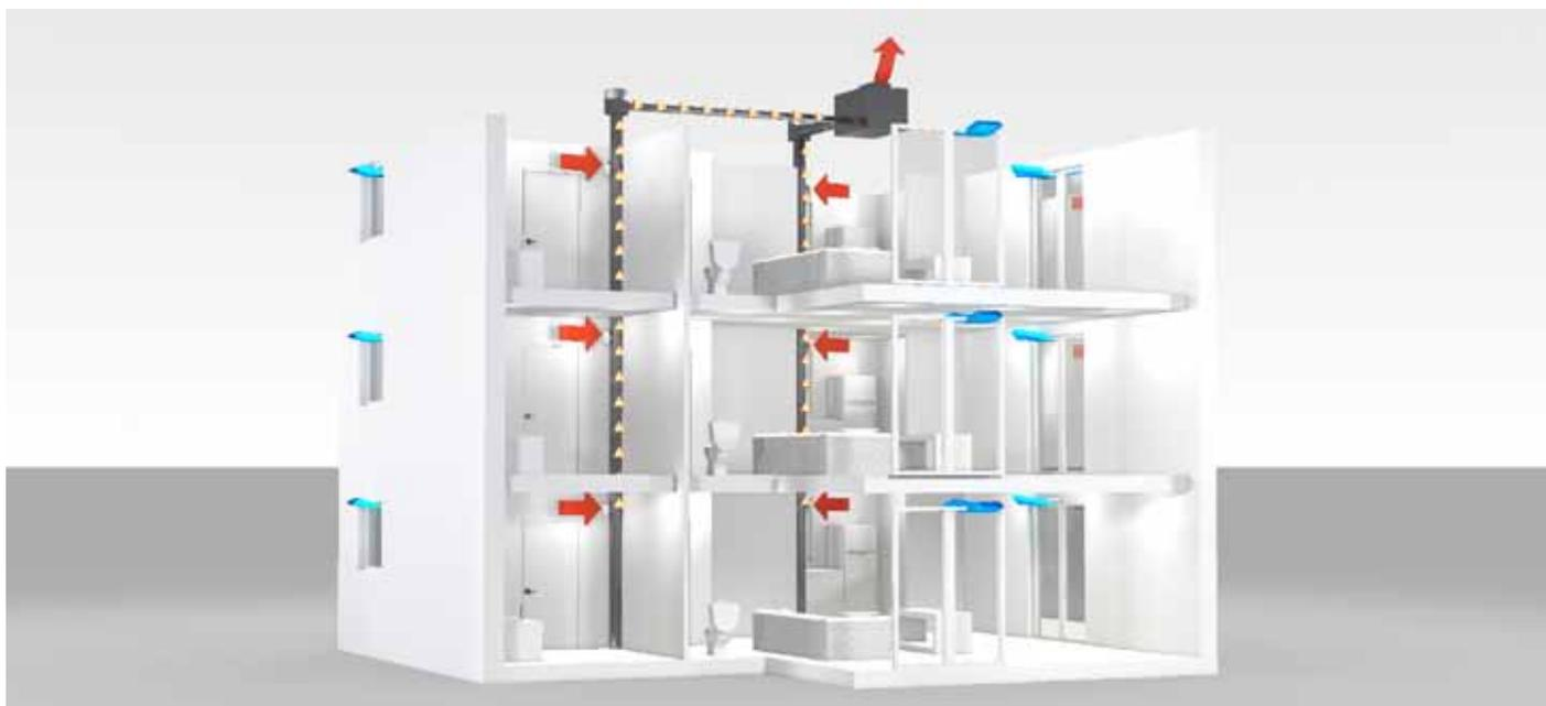
Механическая система вентиляции в многоэтажном жилом доме
