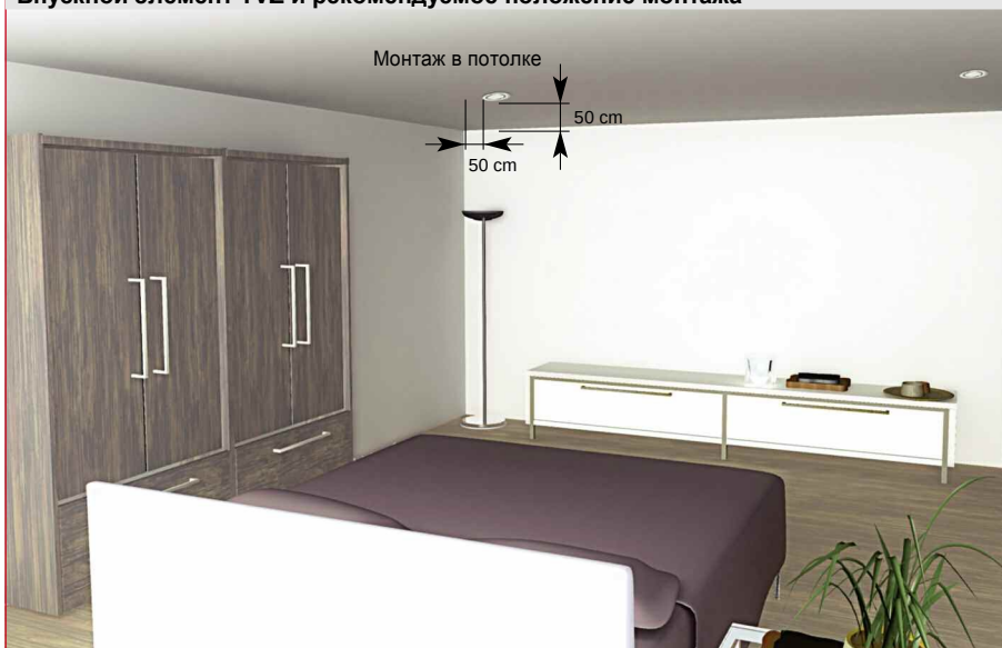
Впускной элемент TVZ и рекомендуемое положение монтажа
