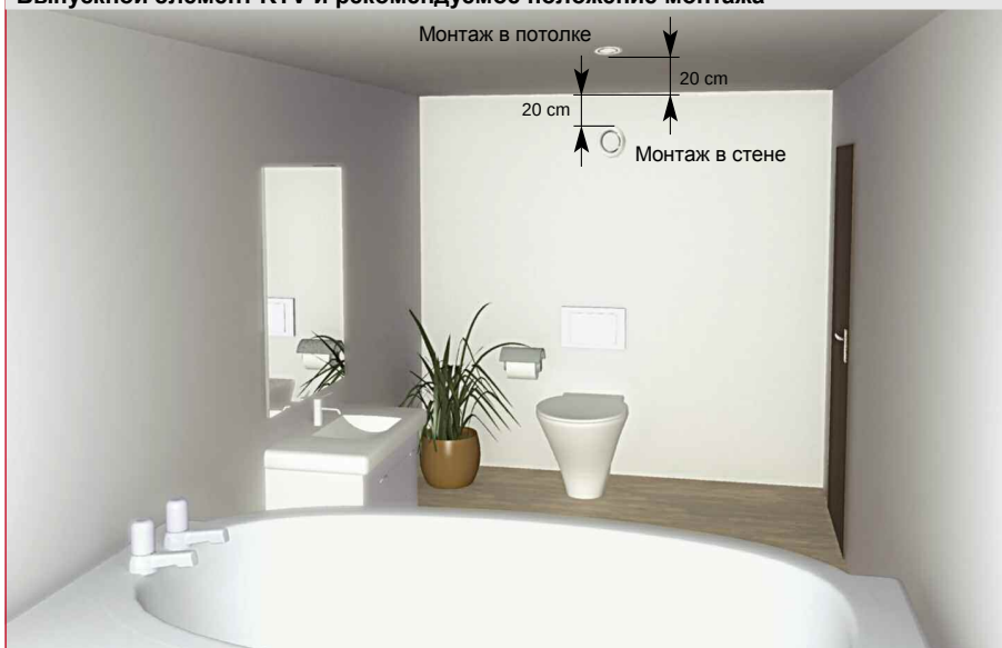
Выпускной элемент KTV и рекомендуемое положение монтажа
